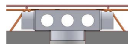
Einbau in die Filigrandecke.
