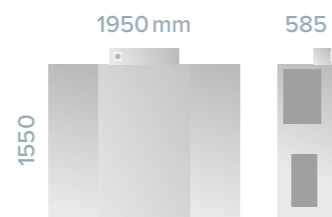
VARIO 2300 CC Gewicht: 292 kg Einsatz: Stand- und Deckengerät
