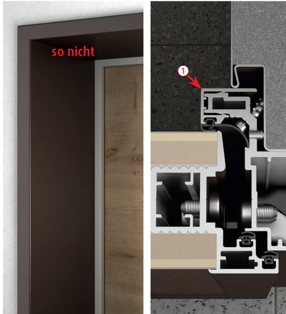
Zur Montage der HOMEtherm® Türen in eine vorhandene Stahlzarge sind zunächst alle alten Dichtungen, Bänder, Schwellen und Schließbleche zu entfernen.
