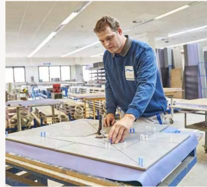
3. Die BadWände und die Dusche Easygo werden im Werk verfliest und mit allen nötigen Leitungen versehen.
