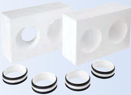
Das kompakte Adapterplattenset aus geschlossenzellig, hoch verdichtetem, wärme- und schalldämmenden Styropor EPS ermöglicht den direkten Anschluss des VALLOX ValloMulti 200 Gerätes an die Integral-Schalldämm-Verteiler RENO, an das flexible Rundrohr, Rohrschalldämpfer und das wärme gedämmte Rohr DN 125. Die mitgelieferten Kurz-Verbinder mit Dichtung gewährleisten eine luftdichte Verbindung zum Rohrsystem.
